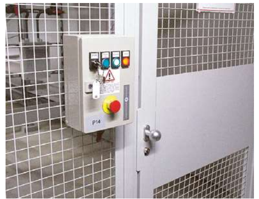
5 Die Drucktaster sind mit Kragen ausgestattet, die ein unbeabsichtigtes Betätigen verhindern.
